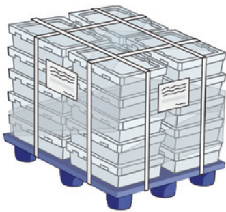
Figure 11 : Palettes emballée sous film plastique et fixée au moyen de courroies croisées
